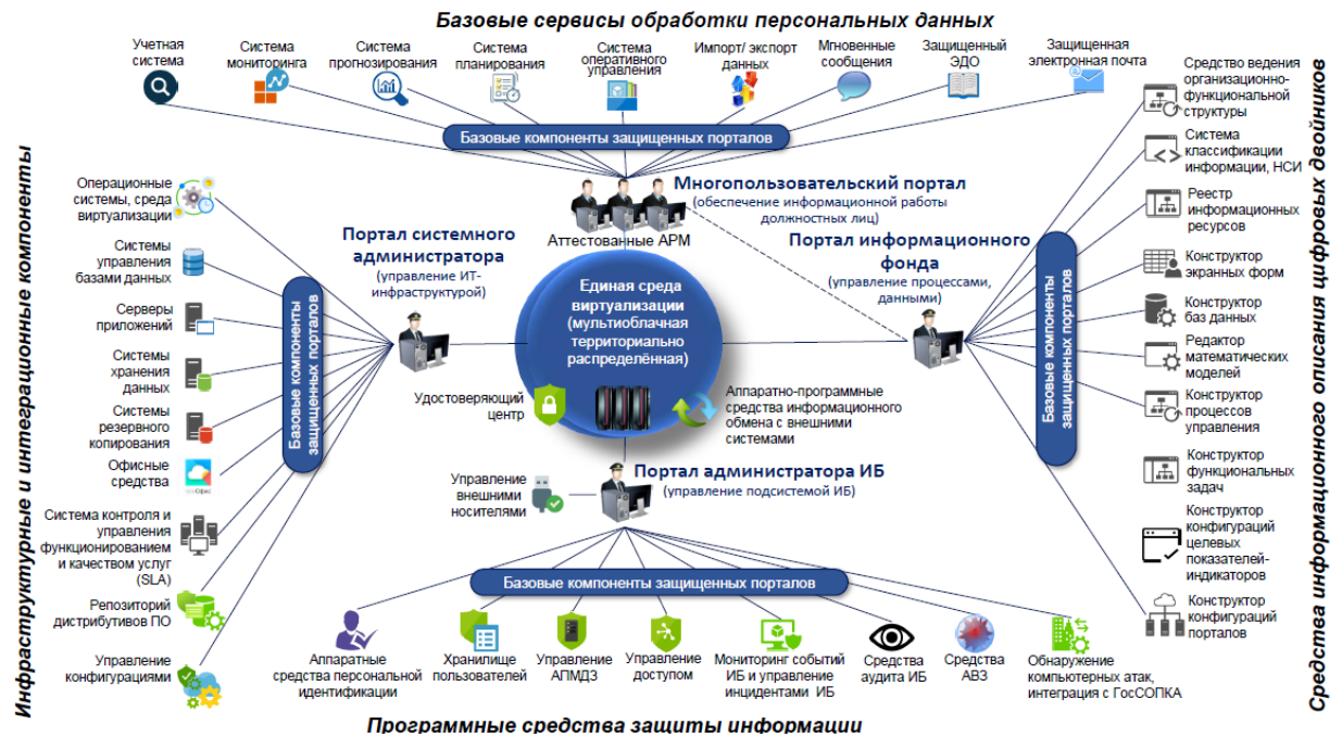
Рисунок 2.10 – Вариант организации ИСПДн на базе мультиоблачной модели
